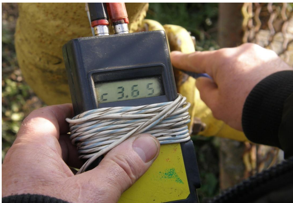
Рис. Д.В.4. Потенціал трубопроводу в зоні дії струмів, що блукають
