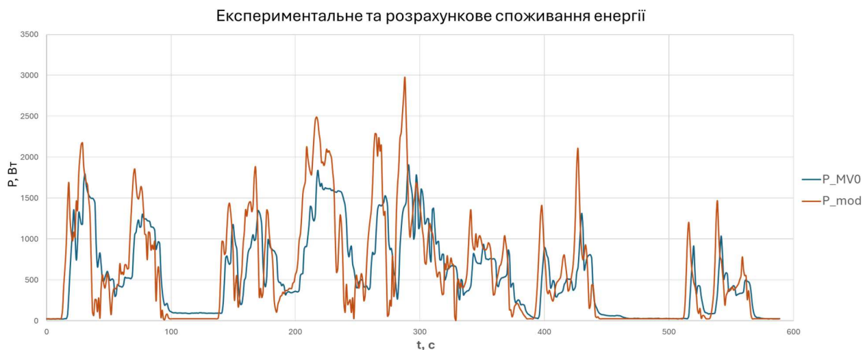
Рис. 3.23 Розрахункове P_{mod} та експериментальне P_{MV0} значення споживаної потужності трициклом
