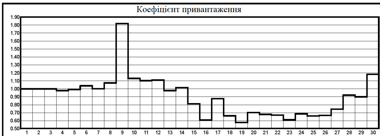
Рисунок 3.5 – Тенденції зміни показників акустичного сигналу за довжиною свердловини №5 на ПК27+6,0
