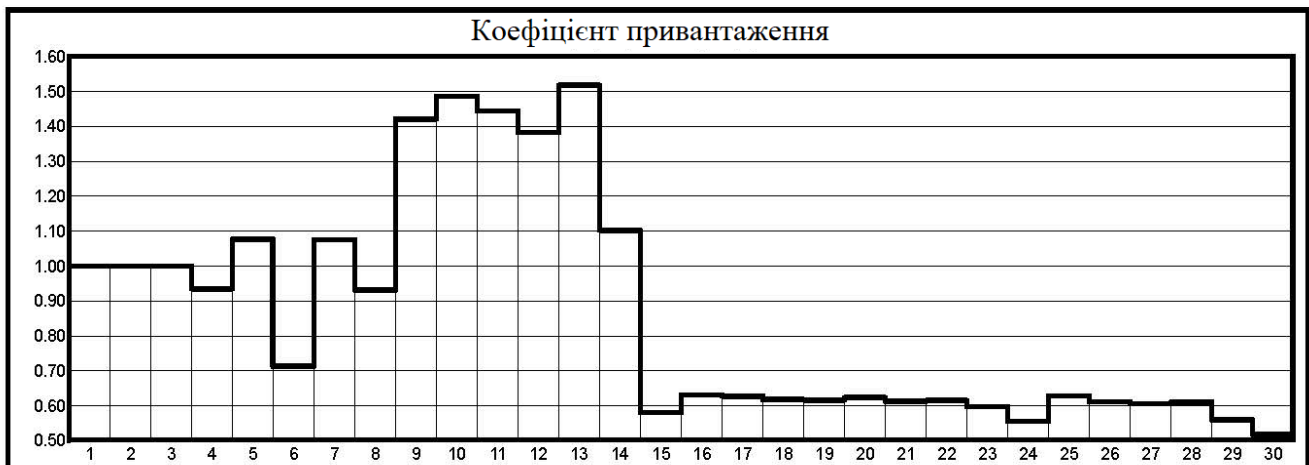
Рисунок 3.4 – Тенденції зміни показників акустичного сигналу за довжиною свердловини №5 на ПК25+6,2
