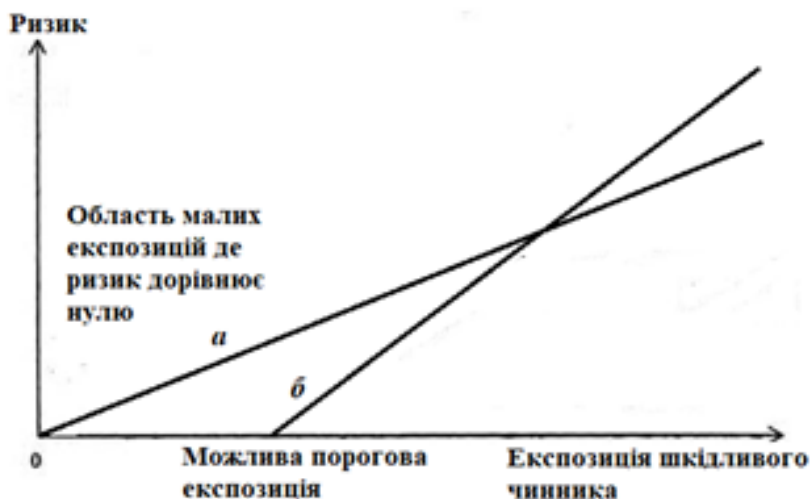
Рис. 2.3. Зв'язок ризику професійного захворювання з експозицією шкідливого чинника: а – за лінійно-безпороговою залежністю; б – за лінійно-пороговою залежністю.
