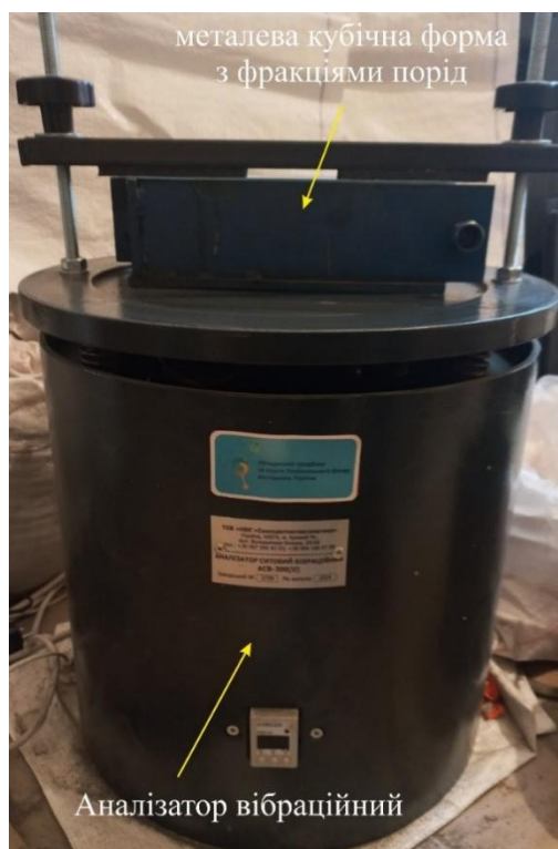
Рисунок 2.6 – Дослідження варіювання пустотності фракцій порід для імітації їх стану в зонах роздрібнення та знеміцнення
