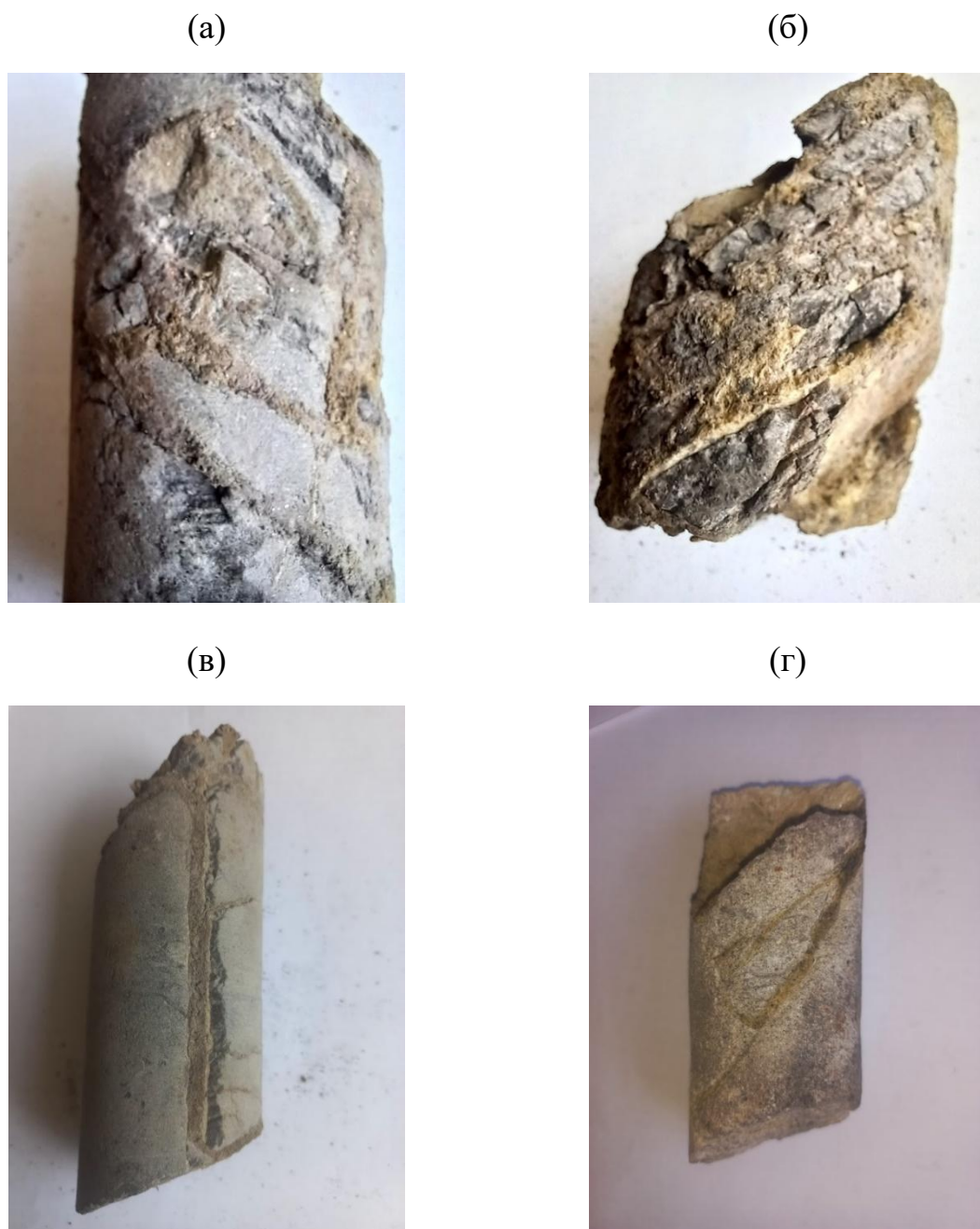
Рисунок 4.4 – Кернові зразки скріпленого поліуретановою смолою масиву гірських порід: (а), (б) конгломерат алевроліту безпосередньої покрівлі; (в), (г) пісковик основної покрівлі
