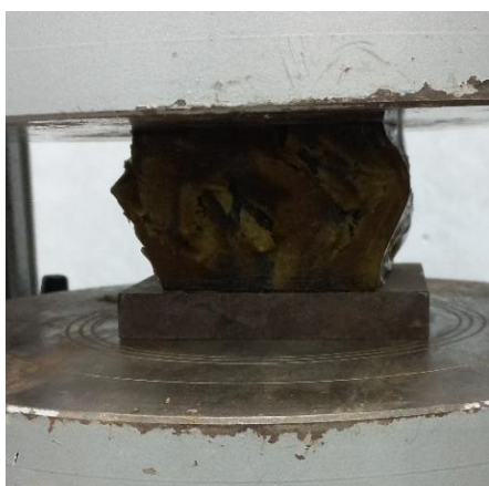
Рисунок 3.5 – Ілюстрація в'язко-пластичного режиму деформування зразків фракцій порід, консолідованих полімерною смолою:
