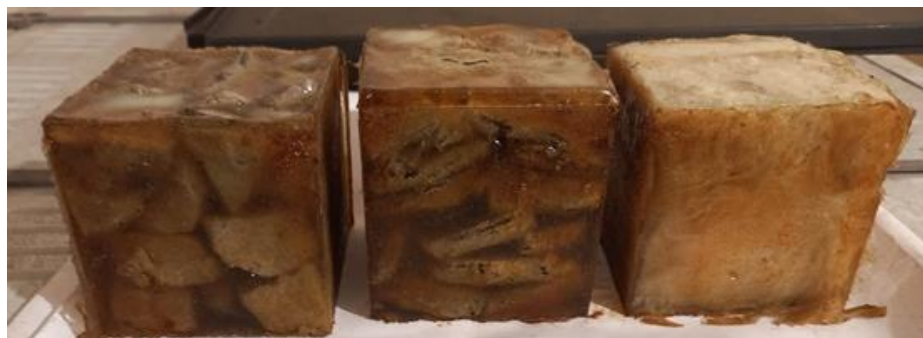
Рисунок 2.9 – Ілюстрація виготовлених зразків консолідованого смолою фракцій порід пісковика та алевроліту з пустотністю 42 – 45% та чистого полімеризованого продукту
