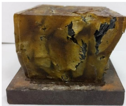
Рисунок 3.5 – Ілюстрація в'язко-пластичного режиму деформування зразків фракцій порід, консолідованих полімерною смолою:
