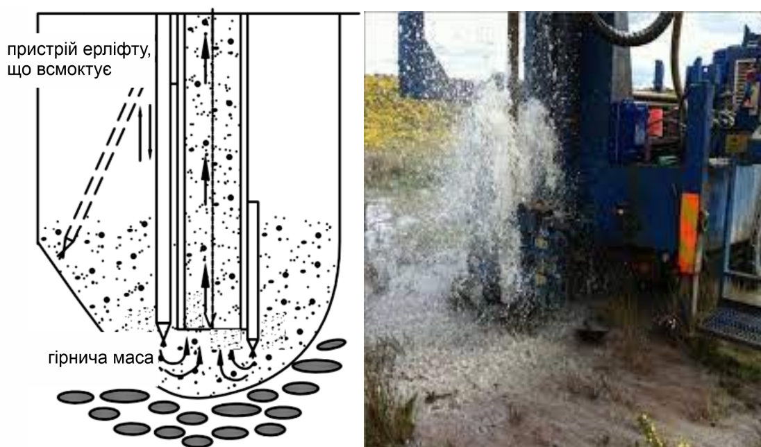
Рисунок 2.1 – Схема ерліфтного гідротранспортування гірничої маси
