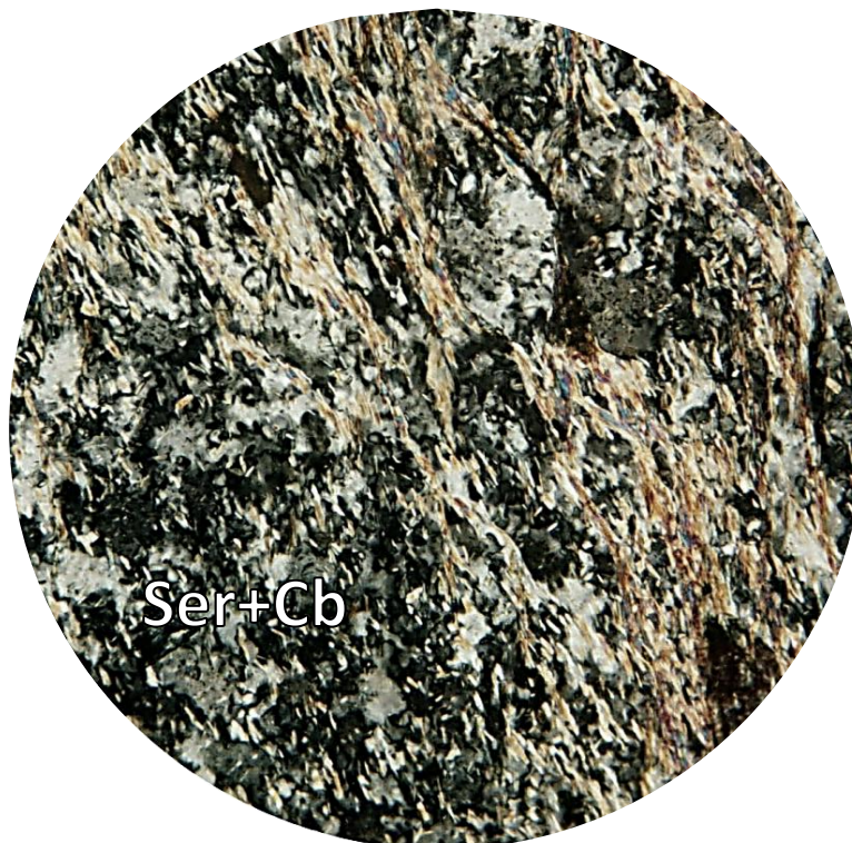
Рис. 3.10 - Метапісковик аркозовий з серицитизованим цементом.
