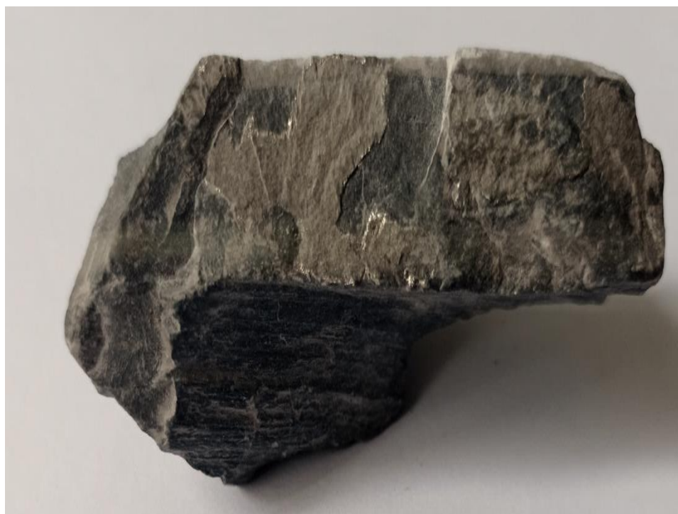
Рис.3.6 – Вуглецевий сланець з піритовою мінералізацією по тріщинах та пірит-кварцевими прожилками.
