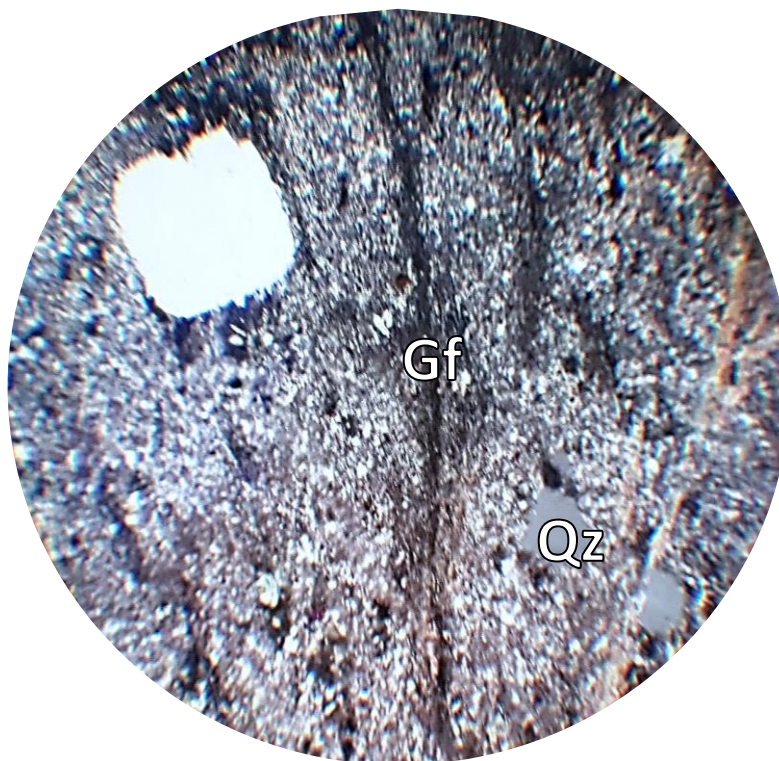
Рисунок 3.20 - Зерно кварцу з «тінями тиску», які виповнені серицит-кварцевою речовиною, графітизація по тріщинах та серицитизація цементу метаконгломератобрекчії.
