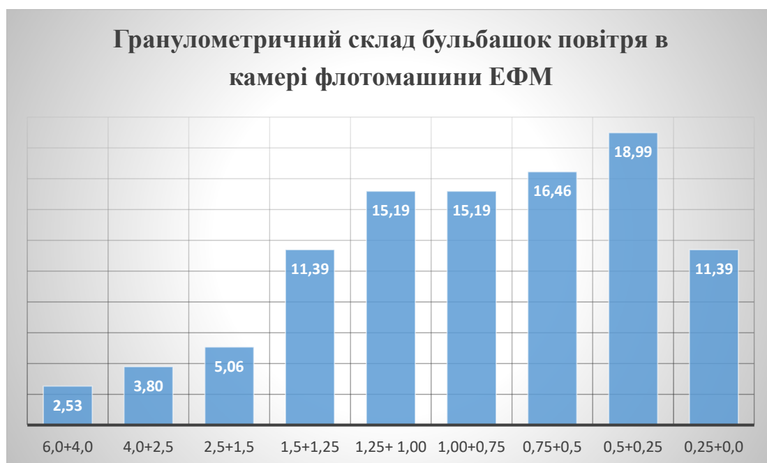
Рисунок 3.5 – Розподіл по крупності бульбашок повітря в камері флотомашини ЕФМ
