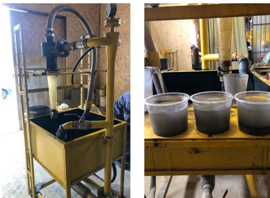
Рисунок 2.9 – Лабораторний гідроциклон для класифікації золи винесення по крупності 40 мкм
