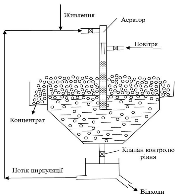
Рисунок 2.22 – Принципова схема роботи ежекторної флотаційної машини ЕФМ з рециклом
