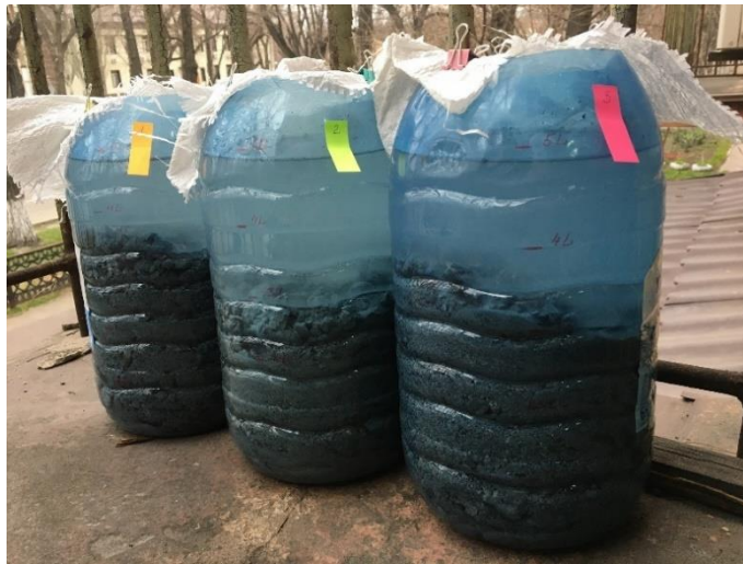
Рисунок 2.7 – Проби металургійних шлаків, що змішуються з контрольною водою для дослідження фізико-хімічних властивостей контактної води (після відповідної витримки)
