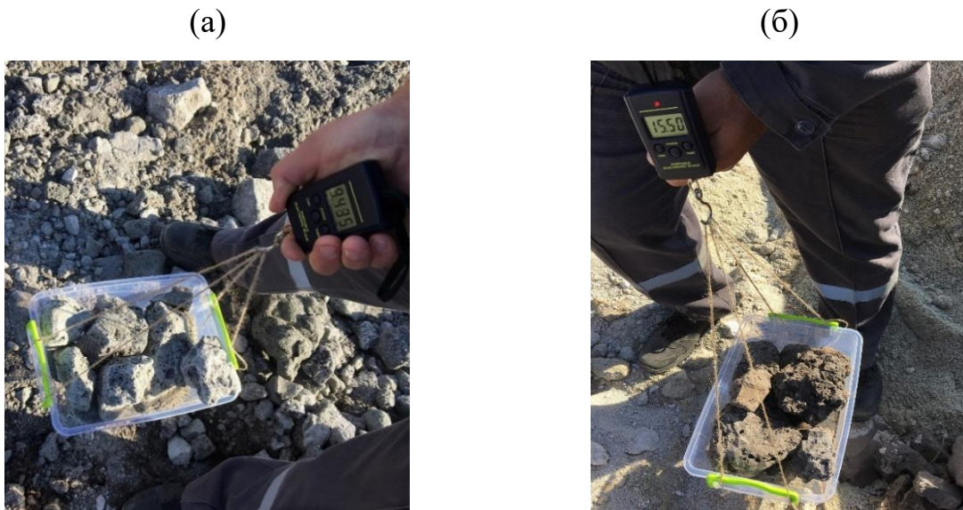
Рисунок 3.21 – Дослідження насипної щільності крупних фракцій доменного відвального шлаку (в межах 400 – 70 мм) (а) та сталеплавильного шлаку (в межах 250 – 60 мм) (б) у польових умовах
