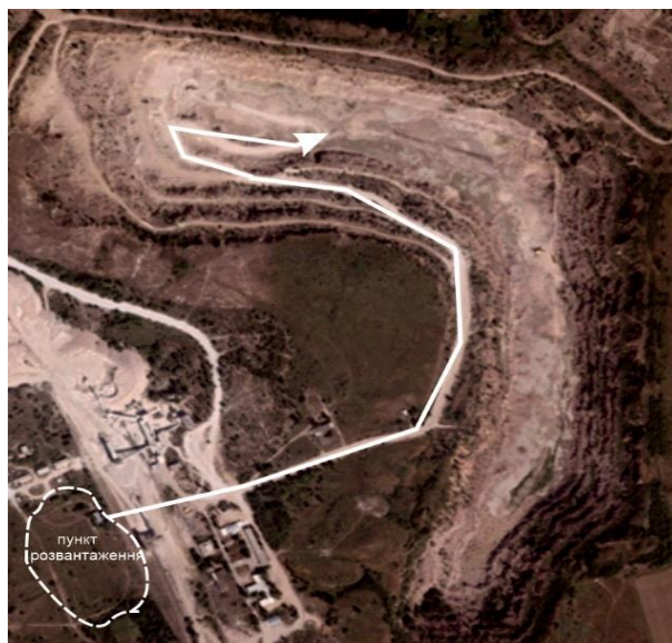
Рисунок 4.5 – Пункт розвантаження і транспорт матеріалу до виробленого простору кар'єру
