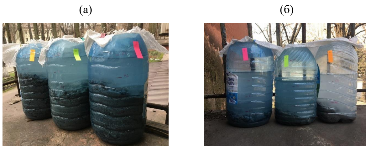
Рисунок 3.2 – Дослідження продуктів взаємодії металургійних шлаків з кар'єрною водою при співвідношеннях 2:1 (а) та 1:2 (б) при первинній витримці
