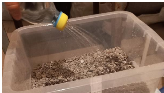
Рисунок 3.18 – Імітація впливу опадів на змодельований закладний масив
