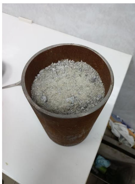
Рисунок 3.24 – Дослідження усадки закладних матеріалів на пресі
