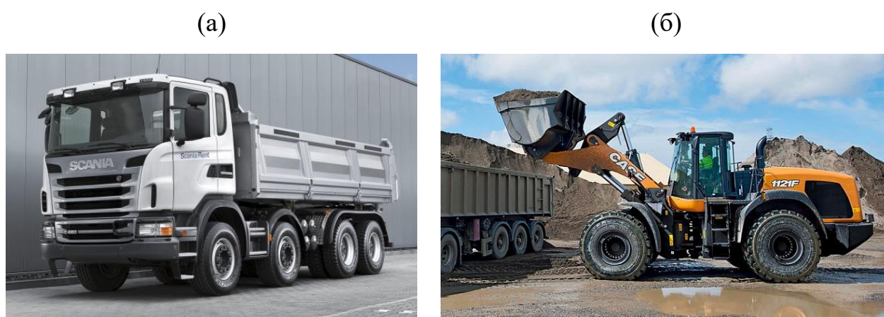
Рисунок 4.6. – Загальний вигляд автосамоскида Scania G480 (а) та навантажувача фронтального CASE 1121F (б)
