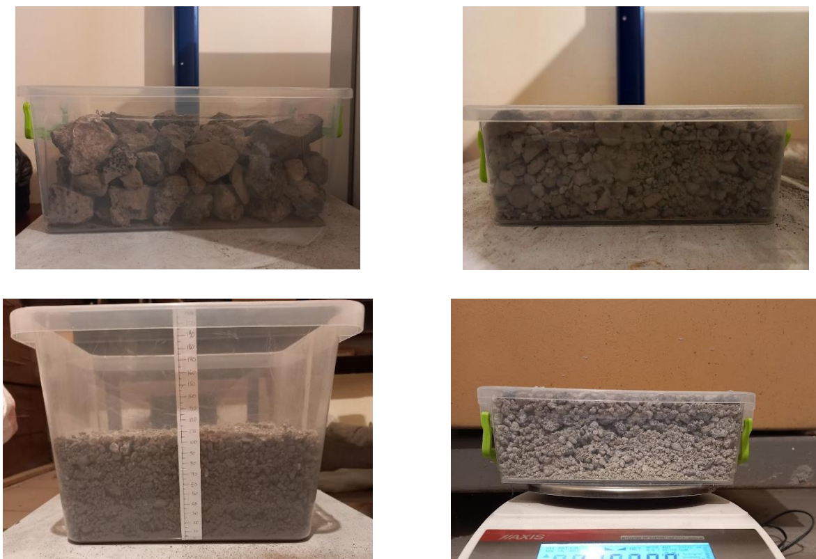
Рисунок 3.22 – Дослідження насипної щільності фракцій доменного відвального шлаку (в межах 70 – 0 мм) та сталеплавильного шлаку (60 – 0 мм) у лабораторних умовах
