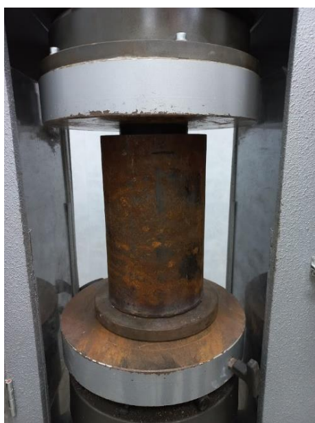
Рисунок 3.24 – Дослідження усадки закладних матеріалів на пресі
