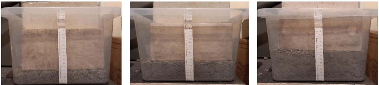
Рисунок 3.17 – Формування фізичної моделі донного закладного масиву з навантаженням
