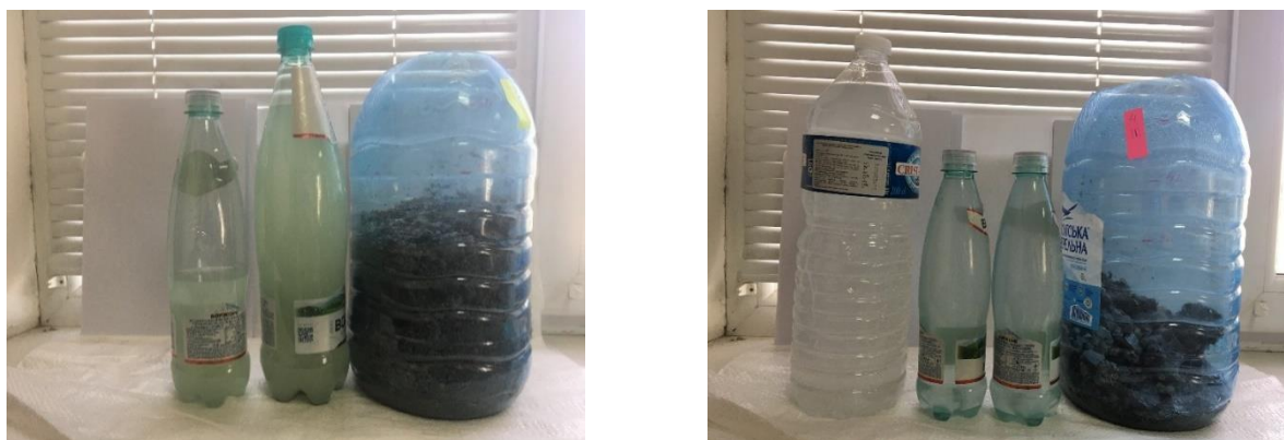
Рис. 3.4 – Відбір розчину шлаку з кар’єрною водою після їх взаємодії для дослідження хімічного складу та забруднюючих речовин
