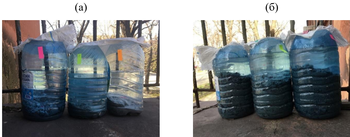
Рисунок 3.3 – Дослідження продуктів взаємодії металургійних шлаків з кар’єрною водою при співвідношеннях 2:1 (а) та 1:2 (б) при вторинній витримці
