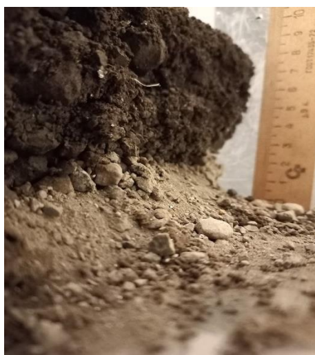
Рисунок 3.19 – Глибина проникності величини атмосферних опадів в неущільнений закладний масив
